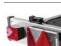
Schnellspannverschluss an der ausziehbaren Lichtleiste zur Arretierung
