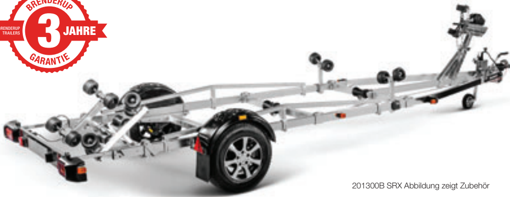
Hochbelastbare Premium Super Rollen mit Soft-Top-Beschichtung
