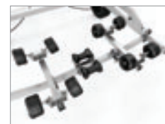
Hochbelastbare Premium Super Rollen mit Soft-Top-Beschichtung
