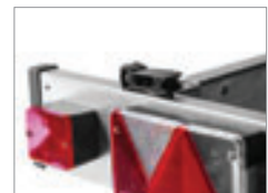
Schnellspannverschluss an der ausziehbaren Lichtleiste zur Arretierung
