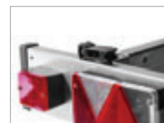
Schnellspannverschluss an der ausziehbaren Lichtleiste zur Arretierung
