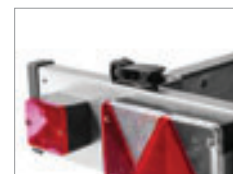
Schnellspanverschluss an der ausziehbaren Lichtleiste zur Arretierung
