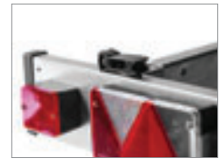
Schnellspannverschluss an der ausziehbaren Lichtleiste zur Arretierung
