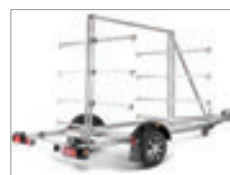
Platz für bis zu 8 Kanus oder 16 Kajaks. Aufnahmearme sind in Distanz, Anzahl und Höhe variabel
